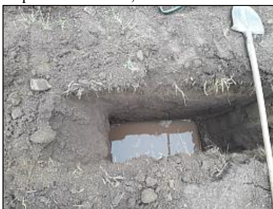
Kopana sonda VS-1, vsakovací zkouška
